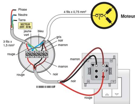
Schéma de câblage d'un moteur S&SO RS100 io Hybrid avec une alimentation par l'inverseur
